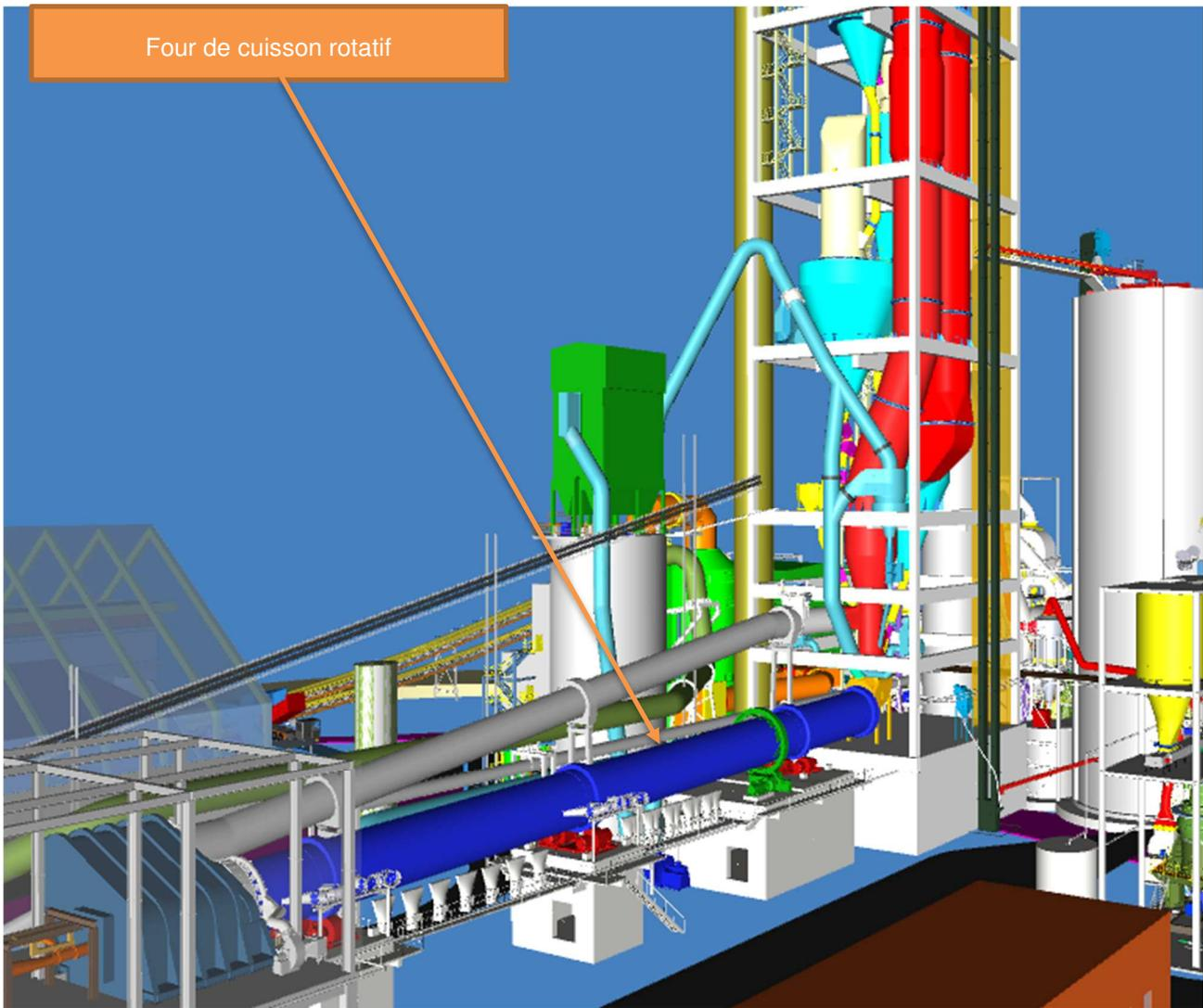
Figure 22 : Localisation du four rotatif (Source : CIMENTS CALCIA)
